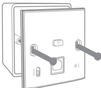
4 根据图示方向固定壳盖，完成安装。
