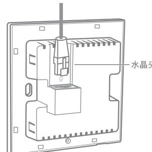
3 对准设备与暗盒上的螺丝孔，装入螺钉以固定，请勿将螺钉拧得过紧。
