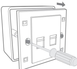
2 请将墙壁中的网线接上水晶头，并将其插入背面板相应接口；
